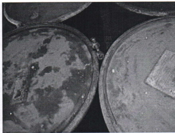
Fotografías No 5. Tanques donde se almacenan los residuos o desechos contaminados con PCB.
